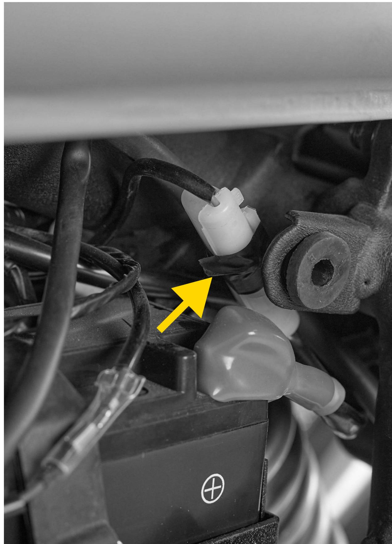
Ни при каких обстоятельствах не допускается установка более мощного предохранителя или его ремонт. Это может привести к повреждению всей электрической системы мотоцикла или возгоранию!
