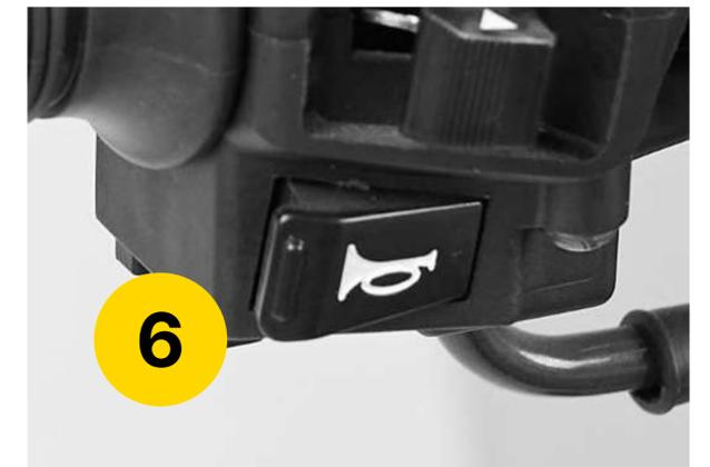
Кнопка звукового сигнала [6] расположена в нижней части пульта на левой стороне руля.
