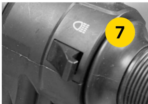
Кнопка стробоскопа [7] кнопка включения и выключения дальнего света фары.
