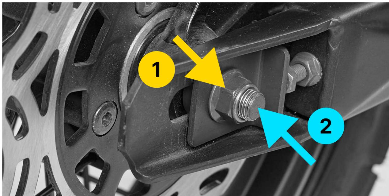
Если колесо демонтировано, тщательно очистите резьбу оси колеса [2] и гайку [1].
